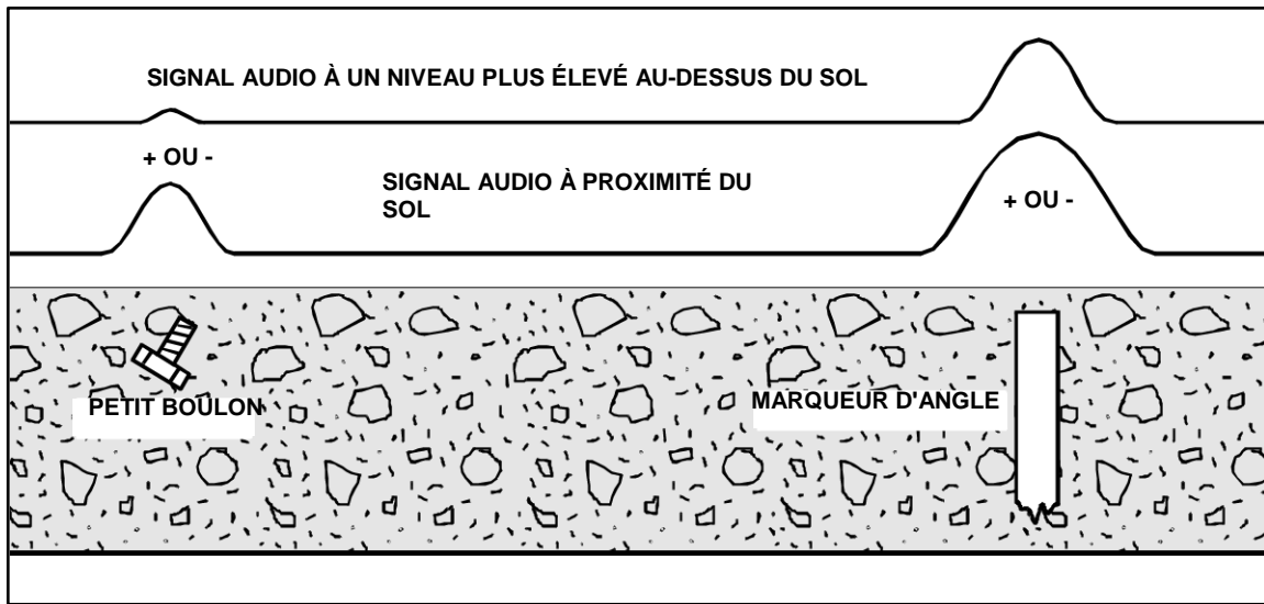
Figure 9. Le fait de relever le localisateur élimine les signaux indésirables
